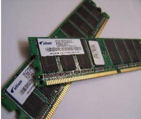
A memória RAM é um tipo de tecnologia que permite o acesso aos arquivos armazenados no computador. Diferentemente da memória do HD, a RAM não armazena conteúdos permanentemente. É responsável, no entanto, pela leitura dos conteúdos quando requeridos. Ou seja, de forma não-sequencial, por isso, a nomenclatura em inglês de Random Access Memory (Memória de Acesso Aleatório).
